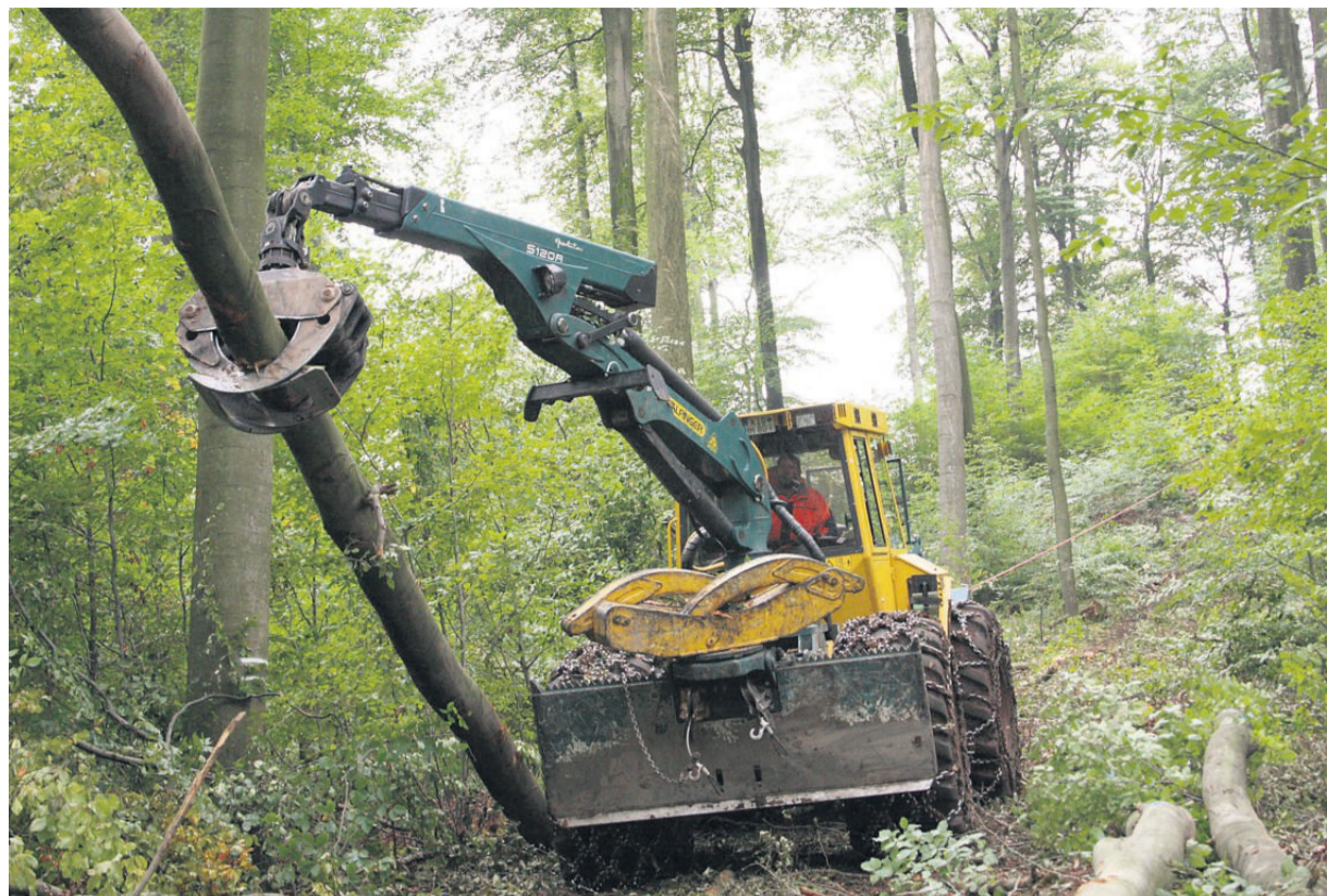
Der neue Rücketraktor aus Hohenlohe kann auch an den Hängen dank neuartiger Technik so arbeiten, dass keine tiefen Spuren entstehen. Das Spezialseil kann mit bis zu 20 Tonnen belastet werden.
